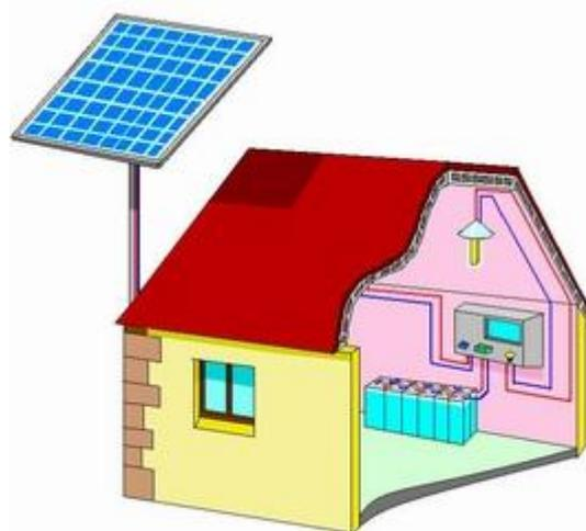
En primer lugar la luz solar incide en los paneles o módulos fotovoltaicos formados por un material semiconductor de silicio cristalino que posee efecto fotoeléctrico, es decir, transforma (con un rendimiento aproximado de 18%), la luz solar en energía eléctrica continua de 12 voltios.
